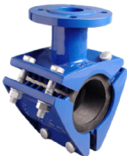
**APLICAÇÃO:** A Abraçadeira de Vedação Tipo B 130 desempenha um papel fundamental ao permitir a perfuração sob pressão de tubulações de gás ou água, além de possibilitar a montagem de derivações com flanges de saída. Sua concepção em 3 seções permite sua aplicação em tubos com variações significativas no diâmetro externo, garantindo uma vedação precisa e confiável.
