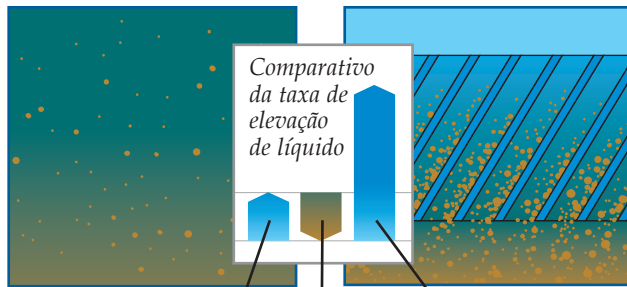
Sem decantadores de alta taxa Com decantadores de alta taxa Velocidade de sedimentação de partículas
